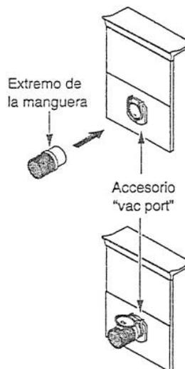
Figura 7 - Conexión del orificio de aspiración.
